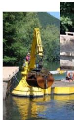
Barge de curage et benne preneuse
