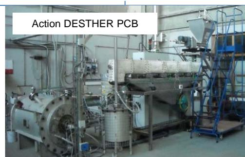
Le procédé de désorption thermique /incinération mis en œuvre à l'échelle pilote sur PROVADEMSE présente l'intérêt d'une destruction des PCB à hauteur de 99,9% (voir le poster de l'action A13 DESTHER PCB)
