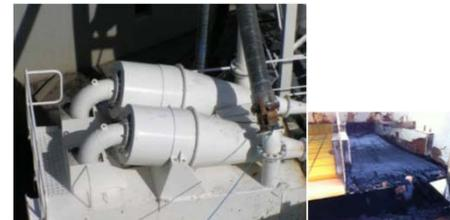
Fig. 4 : Séparation sédiment / CA par hydrocyclonage à l'échelle pré-industrielle
