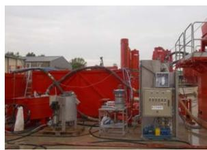
Fig. 3 : Plateforme d'essais de séparation sédiment / CA par aérofloculation à l'échelle pré-industrielle
